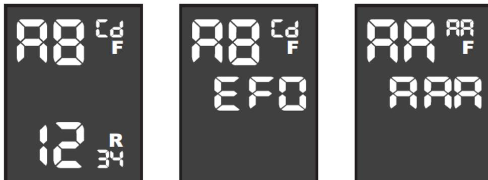
待機狀態下長按「功能表鍵」3 秒鐘，進入系統設置狀態，繼續短按「功能表鍵」7 次進入輪胎配對介面，同時顯示兩輪的「ID」碼，短按「選擇鍵」進入輪胎配對操作子頁面，預設為前輪配對中狀態，通過短按「功能表鍵」可進入後輪配對中狀態，當選中所需配對的輪胎後，螢幕中只顯示該輪位「ID」碼及對應輪位標識不斷閃爍，對該輪胎的發射感測器進行啟動（內置感測器使用充放氣的方式，外置感測器使用重複安裝的方式啟動感測發射器發射信號），當接收器收到對應感測器的信號後，聽到滴滴兩聲並顯示新「ID」碼表示些感測器已成功配對。
