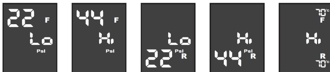
待機狀態下長按「功能表鍵」3 秒鐘，進入系統設置狀態，繼續短按「功能表鍵」2 次進入壓力閥值設置介面，第一項為「前輪低壓」設置，通過短按「功能表鍵」在「前輪低壓」->「前輪高壓」->「後輪低壓」->「後輪高壓」各子項進行切換設置，在某一子項通過短按「選擇鍵」進行具體數值調整，調整完畢，通過短按「功能表鍵」保存並跳入下一級設置選項，在最後一項「後輪高壓」短按「功能表鍵」直接跳入「溫度閥值」設置，通過短按「選擇鍵」進行數據調整，調整完畢，短按「功能表鍵」進入系統設置下一項「輪胎配對」設置介面。
